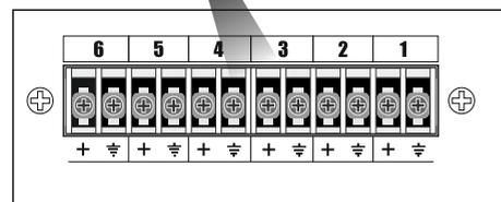
Выходы для подключения громкоговорителей. Обратите внимание, что прибор может использоваться только с 100V трансформаторными системами! Каждая пара 100V-COM соответствует одному каналу. При подключении соблюдайте полярность. Акустические системы в каждом отдельно взятом канале подключаются параллельно. Суммарная мощность всех громкоговорителей на отдельном канале не должна быть больше 60W для VRA-660 и 120W для VRA-6120.
